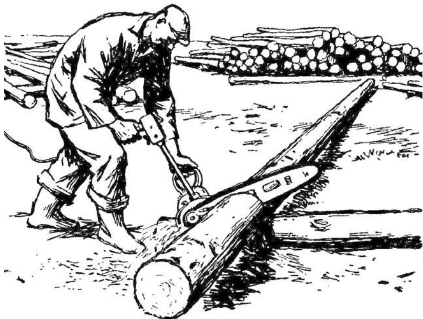
Obr. 4.97 Příčné řezy elektrickou pilou CNIIME K 5 bylo možné provádět při téměř vzpřímené pozici dělníka
