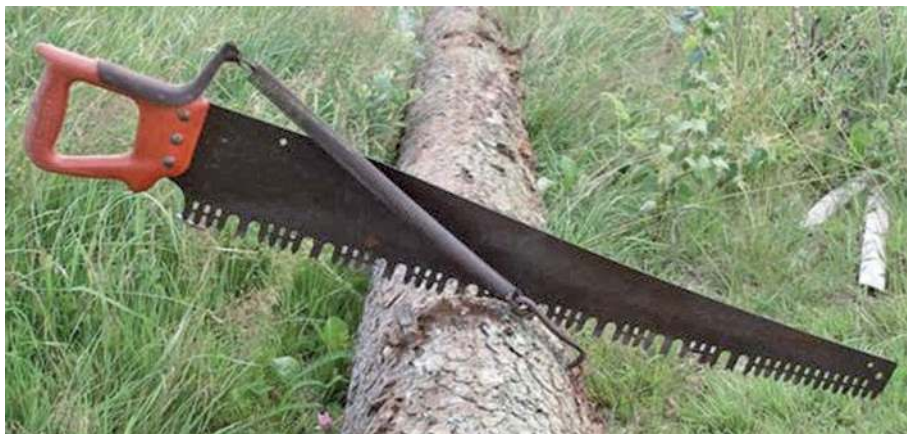
Obr. 4.31 Sågkamraten – spirálová pružina usnadňující pohyb pily „od sebe“ Dostupné online: < http://www.solhem9.se > [3. 2. 2018].
