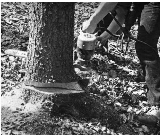
Obr. 4.94 Náhrada záseku dvěma vodorovnými zářezy pilou
