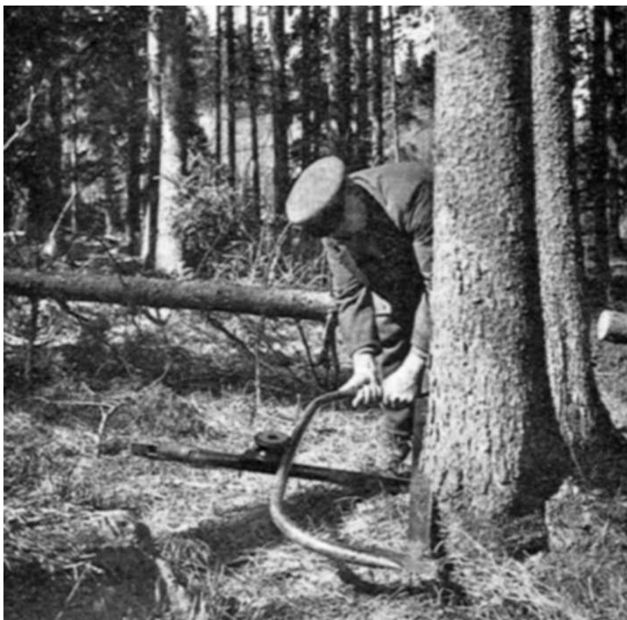
Obr. 4.32 Jerker – pomocné řezací zařízení pro obloukovou pilu (1918) Dostupné online: < http://solhem9.se/overlib421/Jerker.htm > [10. 6. 2018].
