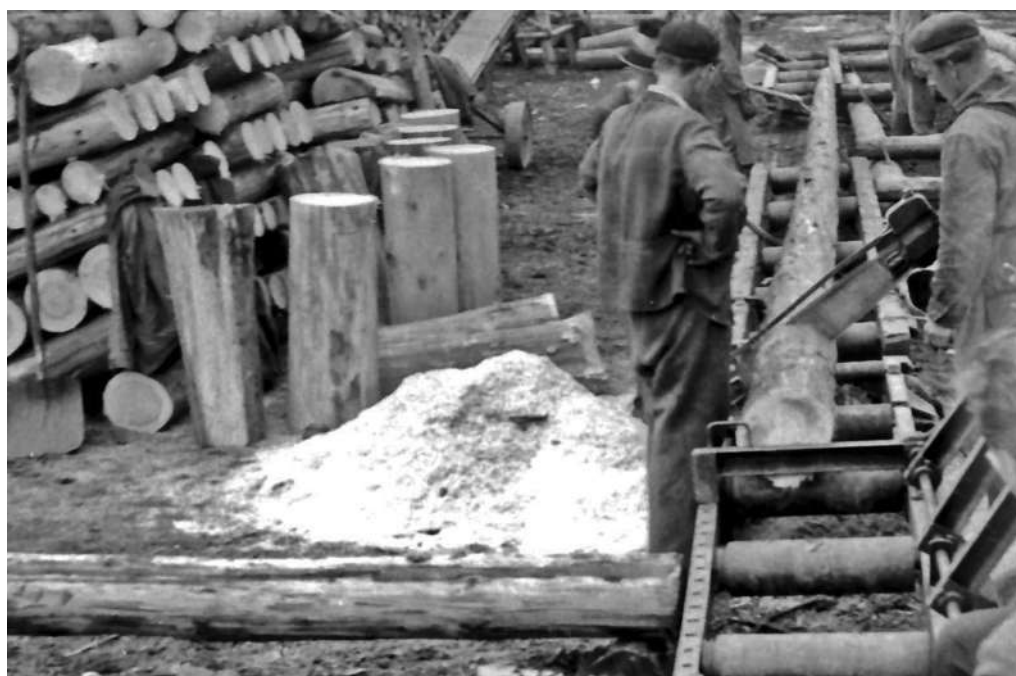
Obr. 5.09 Manipulační uzel vzniklý kyvným umístěním motorové dvoumužné pily na válečkový dopravník
