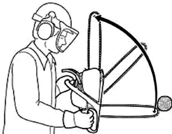
Obr. 3.32 Schéma vzniku zpětného vrhu pily
