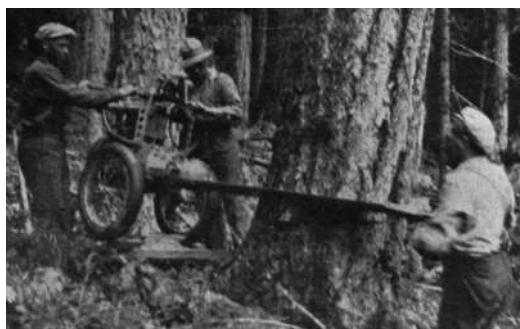
Obr. 4.69 Dow low stump portable power saw, provedení z let 1933–1936
