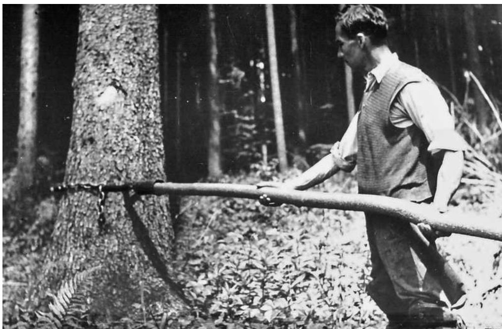
Obr. 5.02 Sepnutí oddenku kmene před manuálním kácením, jako prevence jeho rozštípnutí
