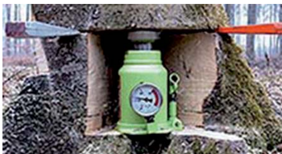
Obr. 5.05 Hydraulický zvedák ve funkci klínu
