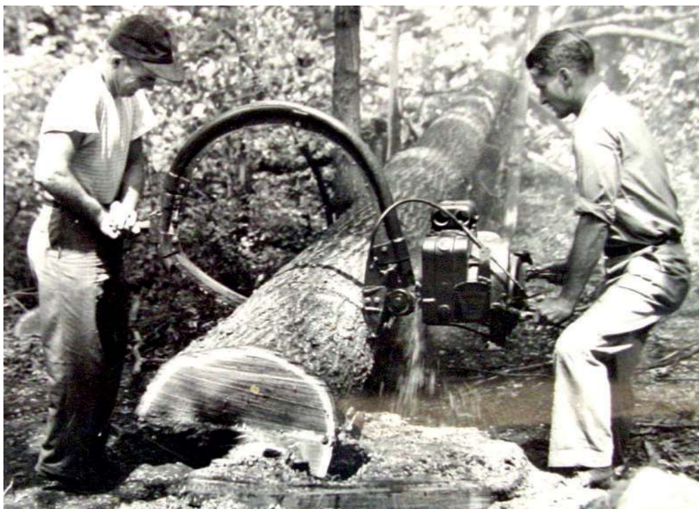
Obr. 1.17 Dvoumužná motorová pila Disston z výbavy ženijních jednotek USA
