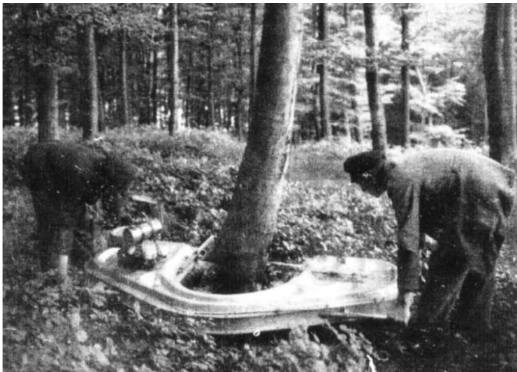
Obr. 4.85 Handbandsäge Bruns (ruční pásová pila Bruns), rok 1932
