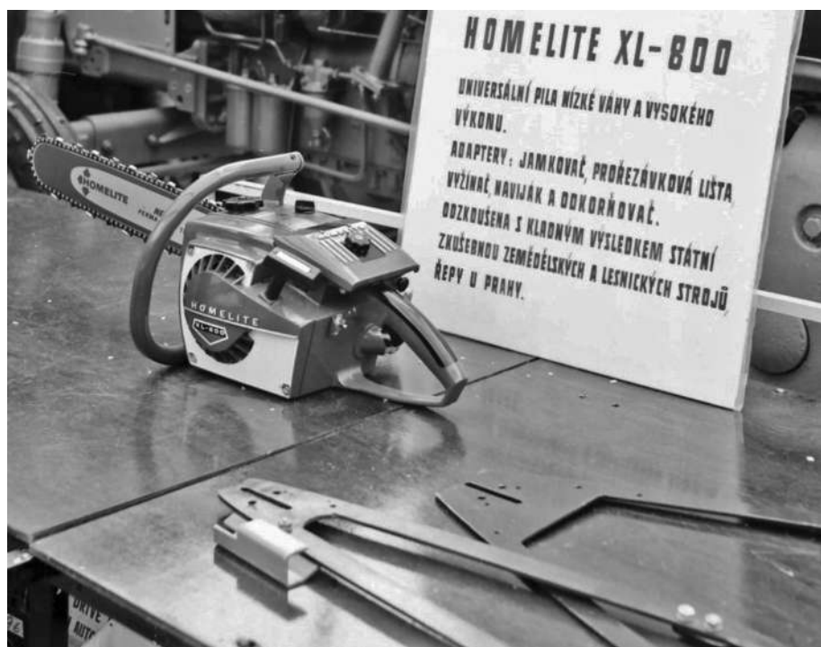
Obr. 4.115 Homelite XL 800 s alternativně dodávanou „prořezávkovou“ obloukovou lištou
