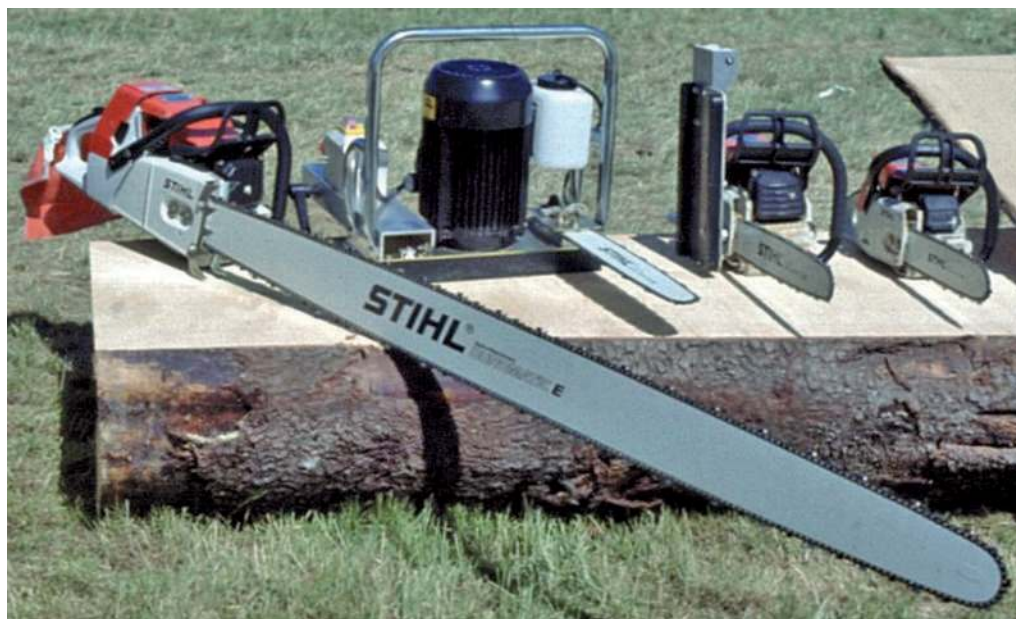
Obr. 4.86 Těžká pila Stihl s dlouhou lištou, určená pro těžbu v tropických lesích
