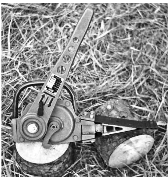
Obr. 5.06 Mechanický klín pro usměrnění pádu stromu při kácení
