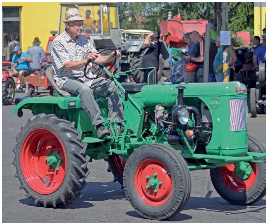
Obr. 4.88 Malý zemědělský traktor Stihl s dvoudobým naftovým motorem
