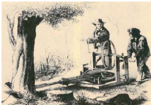
Obr. 4.01 Mechanická Hamiltonova Drag Saw poháněná klikou
