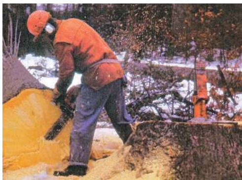
Obr. 5.04 Hydraulický klín odložený na pařezu a schéma činnosti klínu
