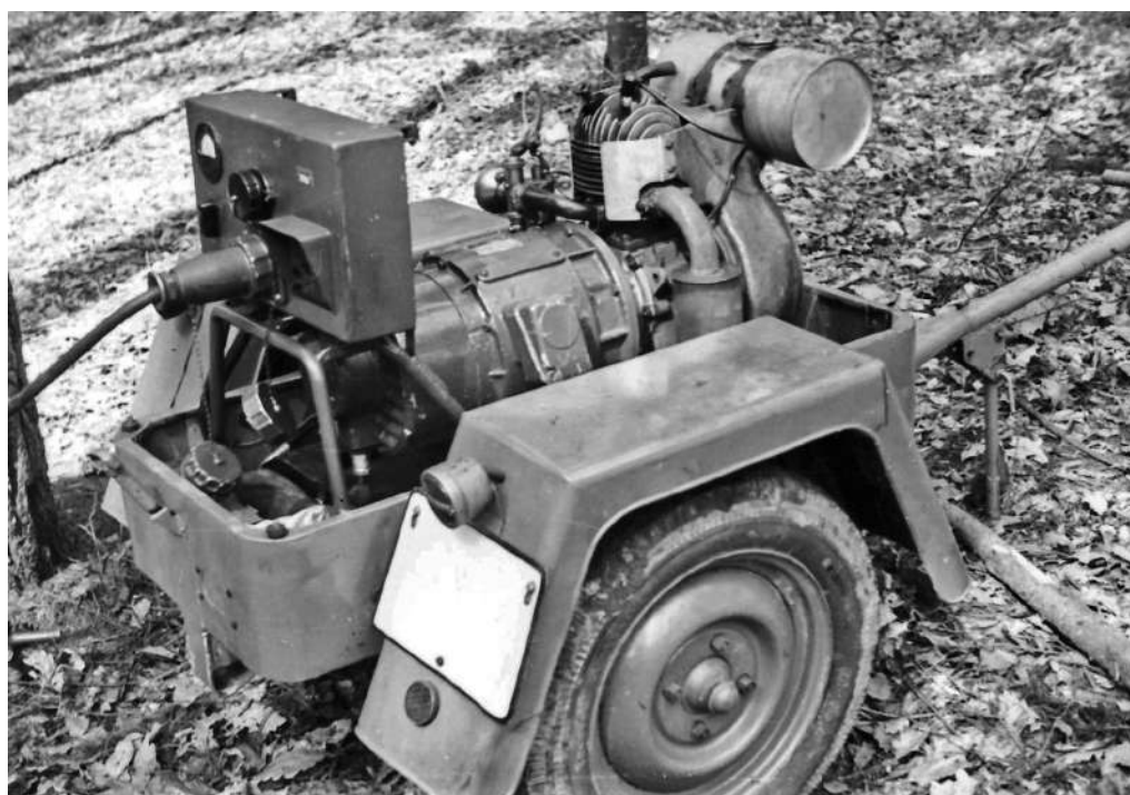
Obr. 4.98 Mobilní generátor proudu se zvýšenou frekvencí
