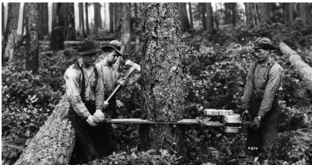
Obr. 4.68 Dvoumužná elektrická řetězová motorová pila Wolf při kácení, kolem roku 1929
