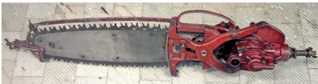
Obr. 4.66 Pneumatická pila Reed-Prentice „Timberhog“ Air Saw s Wolfovým řetězem a motorem Ingersoll Rand
