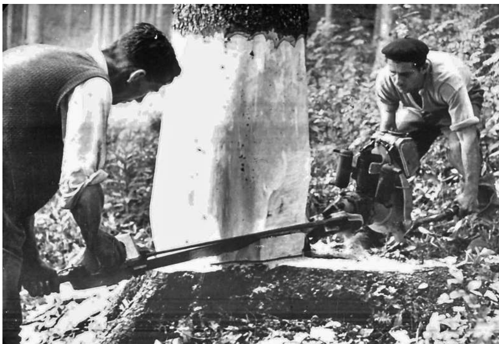
Obr. 4.93 Vyřezávání záseku dvoumužnou motorovou pilou MP-50 s šikmo nastavenou lištou
