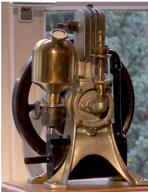
Obr. 4.78 Malý benzinový dvoudobý motor DKW – Des Knaben Wunsch z roku 1919
