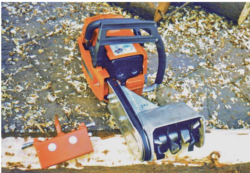
Obr. 1.22 Frézovací odkorňovací adaptér, k jehož pohonu je použita motorová pila Foto Vladimír Simanov, 2014.
