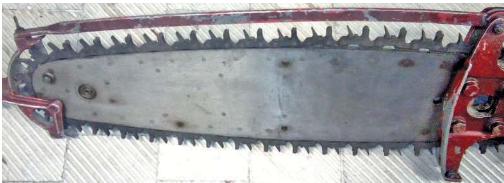
Obr. 3.22 Řetěz Charlese Wolfa na pneumatické pile Reed-Prentice „Timberhog“ Air Saw z roku 1927
