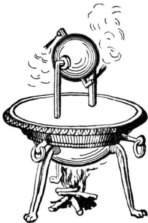
Obr. 4.39 Hérónova parní hračka „Hérónova baňka – Aeolipile“
