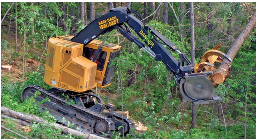
Obr. 2.03 Zakrytovaná okružní pila jako pracovní nástroj káčeče Tigercat L830C 198 Dostupné online: < https://www.tigercat.com/product/5702-felling-saw/ > [9. 5. 2018].
