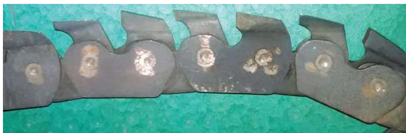
Obr. 3.25 Sekací řetěz Hunziker 245 , pohybující se v liště s ložisky
