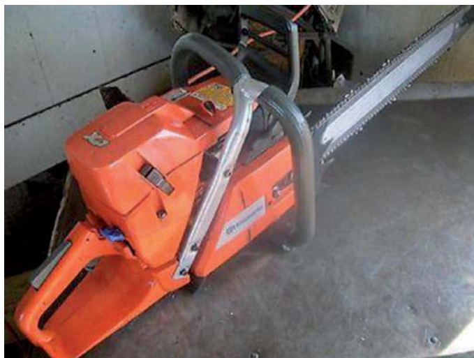
Obr. 2.14 Pila Husqvarna HQ 372 XP s přední rukojetí modifikovanou pro „obě ruce“
