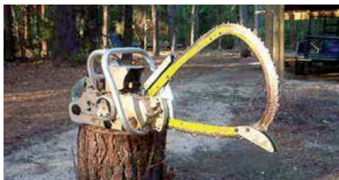
Obr. 3.44 Historická jednodužná pila Poulan s obloukovou lištou
