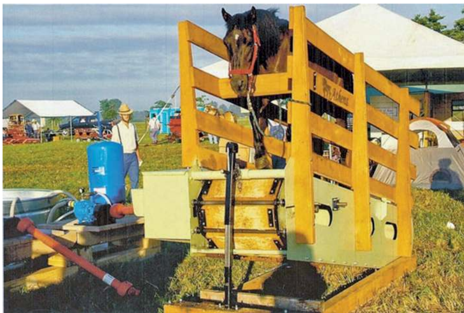
Obr. 4.38 Běžecký treňažér pro koně jako zdroj pohonu na farmě, provedení z roku 2015
